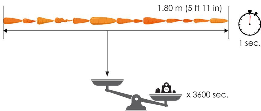
Le poids d'une ligne de 1800 mm de carottes par seconde extrapolé à une heure donne la capacité horaire de tri.
