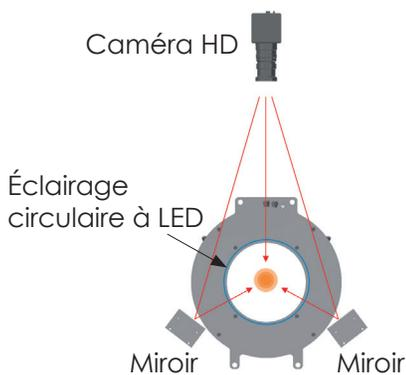
Grâce à un système de miroirs et un éclairage circulaire très puissant, éliminant les effets d'ombre, **chaque produit est parfaitement analysé sur 360°**. Le système optique génère trois images impeccables en haute résolution de chaque carotte. Elles peuvent être affichées instantanément sur l'écran de visualisation de l'ordinateur pour contrôler la détection des défauts.
